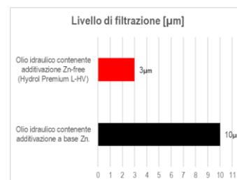
L'assenza di zinco nell'additivazione si traduce in una maggiore filtrabilità e pulizia dell'olio, consentendo di installare filtri più spinti senza problemi di circolazione o impoverimento del lubrificante.
